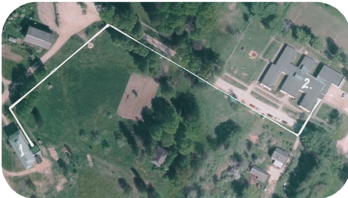
83. attēls. Katlumājas lokācija, apkurināmās ēkas un siltumtrase
